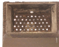
Cuve de combustion nécessitant un nettoyage avec les trous obstrués par des cendres
