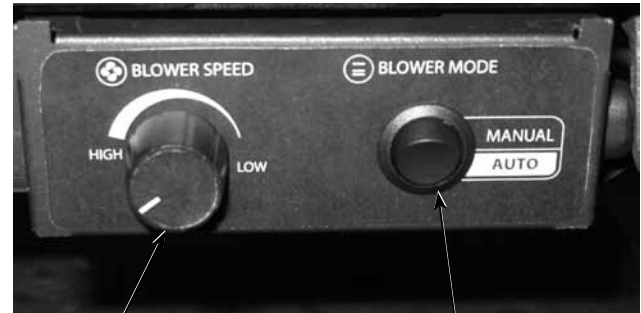
Blower Speed Control Knob (rheostat)
