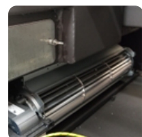
11. Room blower fan
