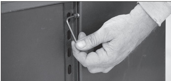
Figure 36 : Retirer les vis du panneau latéral à l'aide d'une clé Allen de 1/8 po
