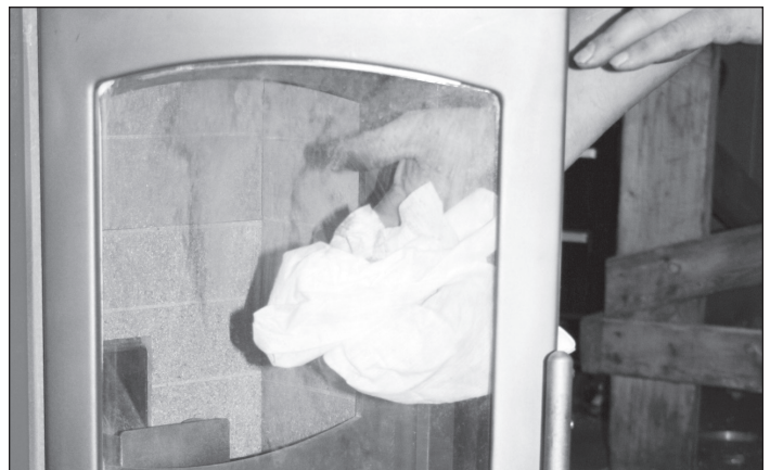
Figure 31 : Essuyer la vitre et contrôler le joint
