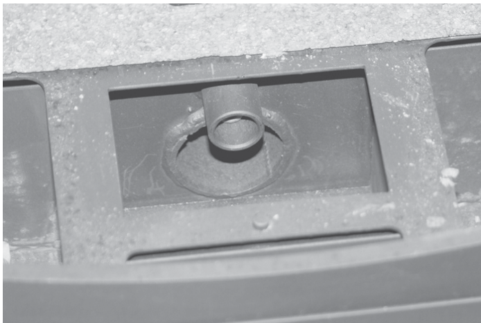
Figure 35 : Enlever les cendres du tube d'allumage (sous la boîte à feu)
