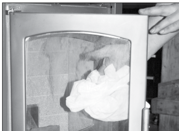
Figure 15 : Essuyer la vitre et contrôler le joint
